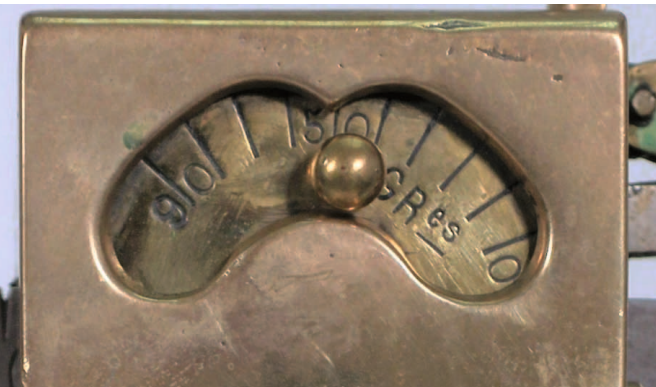
Abb. 15 : Drehmechanismus zur 10-g-Einstellung
