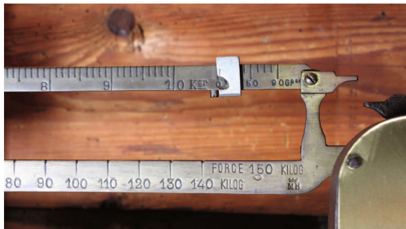
Abb. 3: Vorderes Balkenende mit der dritten Skale in 10-g-Teilung
