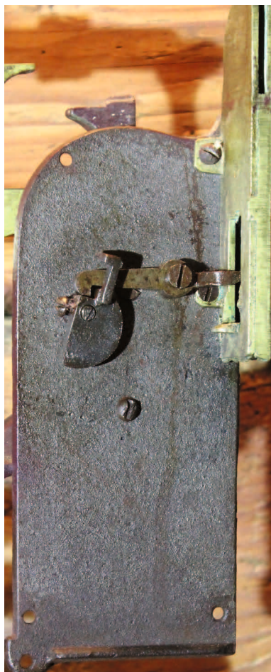
Abb. 6: Münzeinwurfmechanik nach Entfernung der Abdeckung
