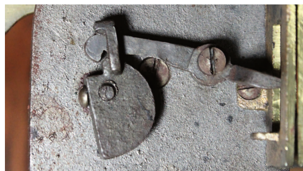
Abb. 9: Eingeworfene Münze hebt Hebel an
