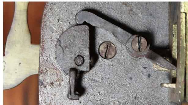
Abb. 11: Arretierungshebel vollständig gedreht, Geld fällt in den Münzkasten
